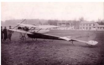
Cet aéroplane a été conçu, selon l'expression même de Denhaut, comme un « biplace de course ». Il s'agit d'un petit biplan à ailes inégales, le plan supérieur est décalé en arrière. Ce décalage des plans évite entre eux le freinage de l'air. Les deux ailes sont facilement
